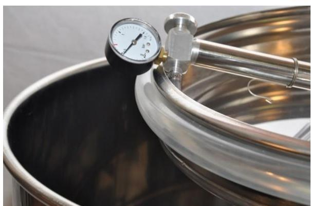
Многие виноделы используют эти ёмкости и для брожения. Для этого надо открутить дыхательный клапан крышки, и вкрутить клапан, (специально изготовленный для плавающей крышки), дающий возможность брожения с водяным затвором.
